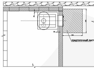
Рис. 3. Схема установки печи Kennet Пропар 18 М23, вид сверху и сбоку.
